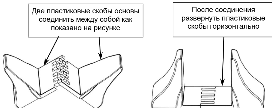
Рисунок 3 - Сборка пластиковых основ для вертикальной установки изделия.
